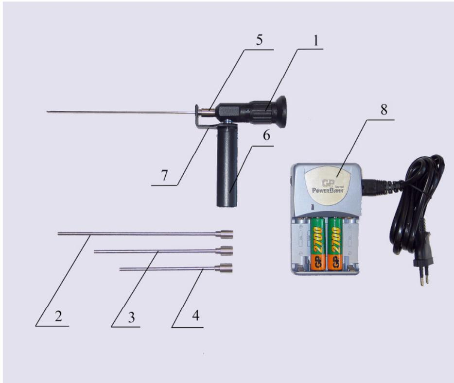
Рис. 1. Основные составные части комплекта эндоскопа. Здесь: 1 - оптическая трубка; 2 - защитный кожух длинный для оптической трубки; 3, 4 - защитные кожухи укороченные для оптической трубки; 5 - втулка упорная; 6 – переносной блок осветителя; 7 – фиксатор; 8 – зарядное устройство с сетевым жгутом для сети 220В.
